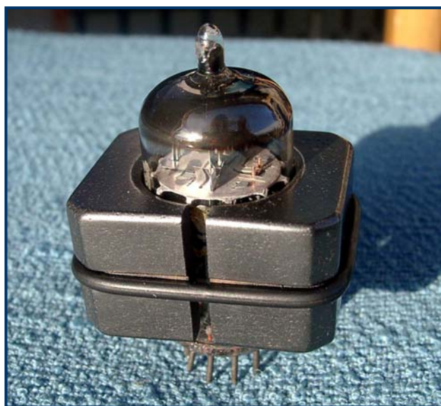
Figura 12 : Smorzatori in carbon block per valvole Clinamen Audio
