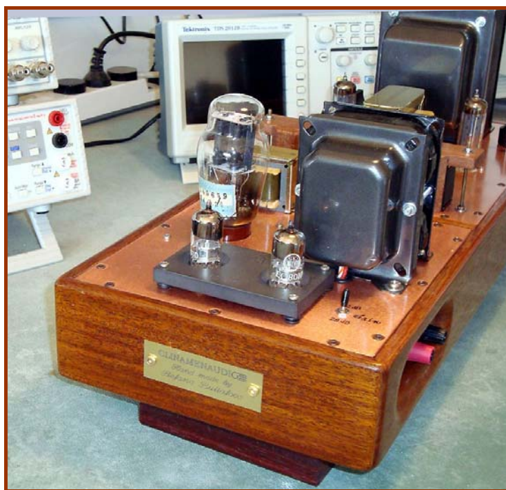
Figura 5: Monotriodo mono CLINAMEN AUDIO con evidenza il TU202/32 Euterpe
