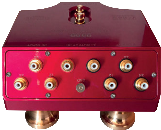
Sul retro troviamo un'uscita e tre ingressi per canale, più la presa di terra.
